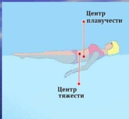
В Мёртвом море действует большая выталкивающая сила, поэтому тело человека выше поднимается над водой и центр тяжести поднимается, оказываясь выше центра плавучести.
